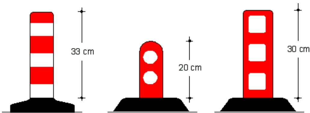
Gli elementi prefabbricati per salvagenti pedonali e **delimitatori di corsia** possono essere realizzati in calcestruzzo, costituiti da sezioni componibili mediante appositi incastri. Essi devono essere impiegati solo nelle zone urbane per la creazione di isole pedonali di rifugio ovvero piattaforme di carico.
